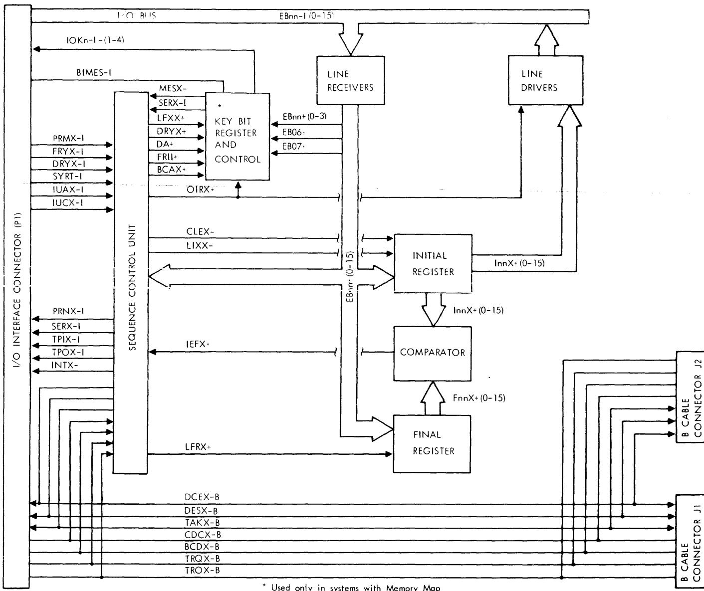
**Figure 4-1. BIC Block Diagram**
